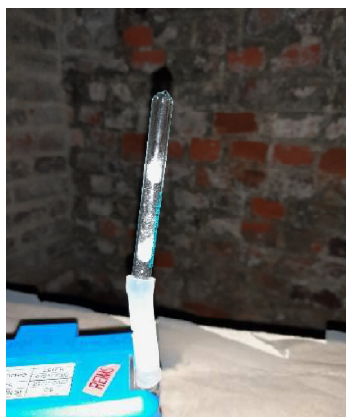
Vue détaillée de la ligne d'échantillonnage
